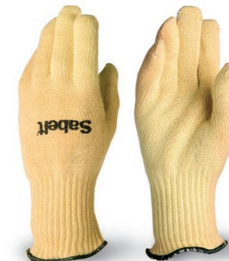
Guanto e manicotto di protezione contro i rischi meccanici e di calore. Tessuto in cotone e kevlar. Protegge fino a 300° C. In accordo con le direttive Europee: -89/686 (dexterity 4) EN420:2003, -EN388:2003. Resistente al taglio (5/5). Resistente all'abrasione (2/4). Resistente agli strappi (4/4). Resistente alla fiamma (4/4). Resistente al calore (2/4).
